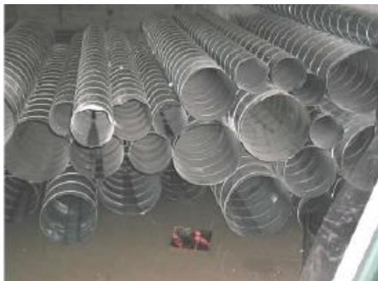
Exemple de stockage de conduits à éviter (exemple français à gauche) et à privilégier (exemple finlandais à droite). Source : Cetiat
